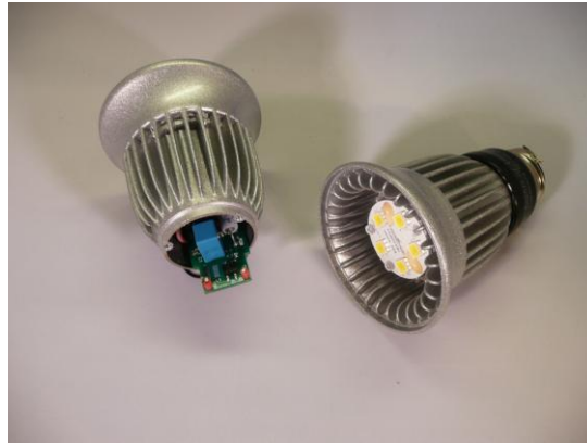
图 1 灯泡替换使电源空间变得极小
