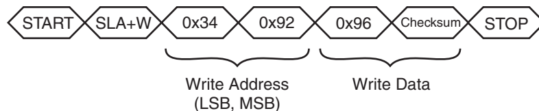
图 8-2: 写入地址 0X1234（包含校验和）的示例
